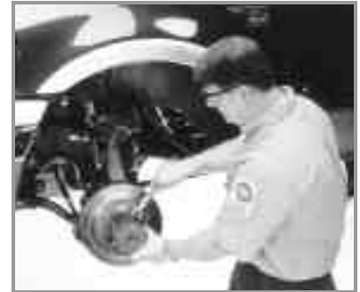
Schritt 1 der 4/9.0 Lösung Der Techniker montiert den Adapter an der Radnabe
