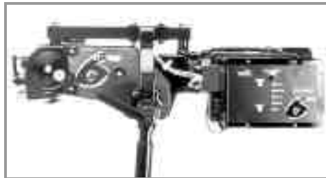
Drehmaschine in Kopfüber–Position. Sie müssen die Drehmaschine in diese Position bringen, um die andere Seite des Fahrzeugs bearbeiten zu können.
