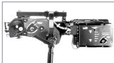
Tour pour frein vers le bas. Vous devrez installer le tour dans cette position pour réusinage l'autre côté du véhicule.
