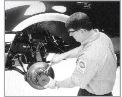
Étape 1 de la solution 4/9.0 : Le technicien installe un adaptateur au moyeu.
